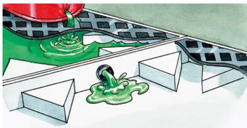
デッキを連結すると、液体は隣接するデッキに流れ込みます。連結する分、容量が増えます。
