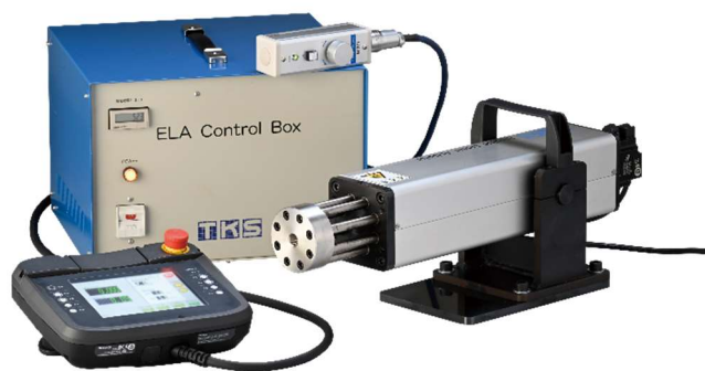
電気サーボ式疲労試験機
